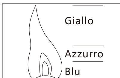
Necessita di pulizia
