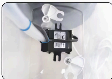
2. Fixe a bomba à calha na parte inferior do depósito
