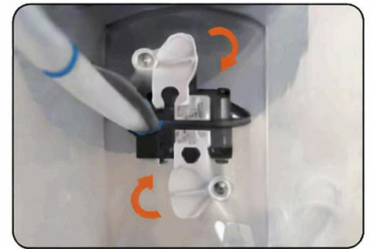
3. Faites pivoter la palette sur la pompe à eau pour la fixer
