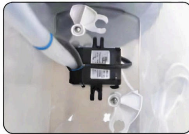
2. Fixez la pompe à l'évidement au fond du réservoir
