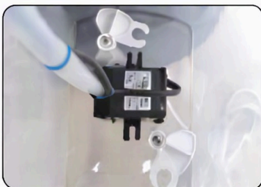
2. Fissare la pompa nella vaschetta sul fondo del serbatoio
