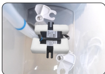
1. Remova a espuma à volta da bomba
