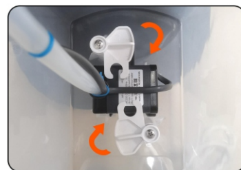
3. Rotiți tableta pe pompa de apă pentru a fixa pompa de apă.
