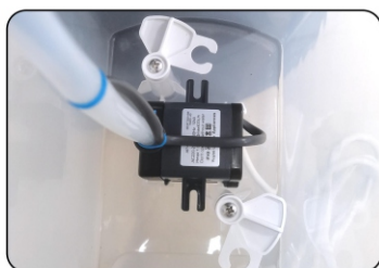
2. Prenda a bomba à calha na parte inferior do depósito
